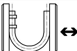
El tubo flexible fijado a una placa base se dobla hasta pandearlo. El valor medido corresponde al ángulo de curvatura mínimo Rmín. Este ángulo Rmín provoca una considerable reducción del caudal.
