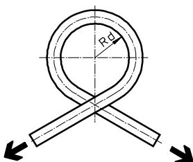
El tubo flexible se dobla en el sentido de su curvatura inherente hasta que su diámetro exterior disminuye un 5 por ciento debido al aplastamiento. A continuación se calcula el radio Rd. Hasta alcanzarse el radio Rd no se produce una reducción del caudal.
