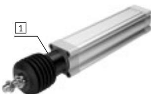
El conjunto de fuelles es un sistema exento de fugas. El aire de alimentación y descarga del conjunto es común a través de un taladro de compensación de presión **1**, para evitar la aspiración de fluidos no deseados. Este conjunto protege al vástago, a la
